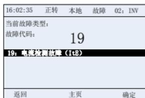
图 2.8 故障告警显示状态图
