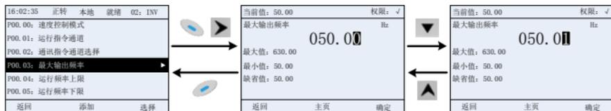
图 2.17 参数设定编辑界面示意图
